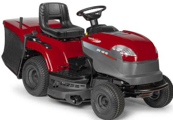
**Rasentraktor mit 240-Liter-Grasfangkorb und einem breiten Mähdeck mit 98 cm Schnittbreite, geeignet für den Grasschnitt in großen Gärten. Angetrieben von einem Zweizylinder-Motor. Pedalbetätigter hydrostatischer Antrieb für einfaches Geschwindigkeitsmanagement. Elektromagnetische Kupplung für mühelose Messerzuschaltung.**
