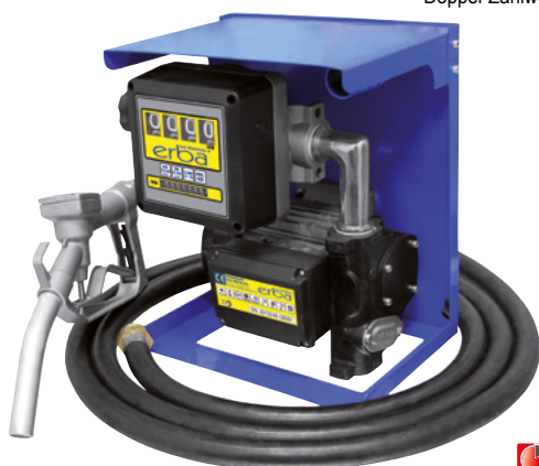
Art.Nr. 66152 • 230 V, 350 W • max. Förderhöhe: 4 m • max. Förderleistung: 3.600 l/h • selbstansaugend: ja • IP-Schutzart: IP 55 • Sauganschluss: 1" IG • Druckanschluss: 1" IG • max. Wassertemperatur: 35 °C • max. Förderdruck: 1,5 bar • Material Gehäuse: Metall • Netzleitung Länge in Meter: 1,75 m • Lieferumfang: Alu-Zapfpistole, Doppel-Zählwerk, Öl-resistente Schläuche
