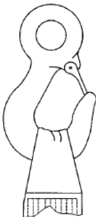
Bild D.1 — Darstellung einer unsachgemäßen Anpassung eines Schlaufengurtbandes an einen Haken mit zu kleinem Radius
