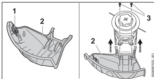
Das Ablängmesser (1) ist bereits in den Schutz (2) eingebaut und darf nicht ausgebaut werden.
