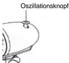
Für die Schwenkfunktion den Oszillationsknopf auf dem Motorgehäuse nach unten drücken. Wenn Sie die Funktion ausschalten möchten, ziehen Sie den Knopf nach oben.
