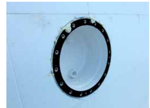
▲ Fertig eingeschäumter Scheinwerfer
