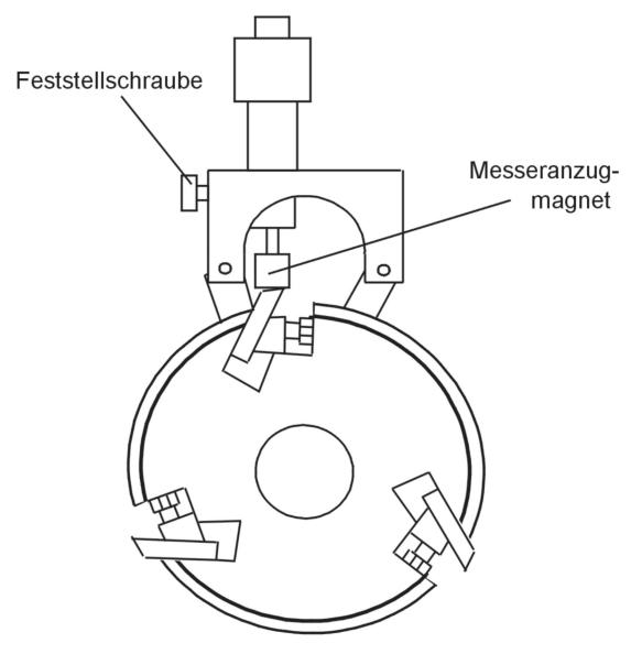
**Einstellung:** Stellen Sie den Messeranzugsmagnet in die gewünschte Höhe und fixieren Sie diese Lage mit der Feststellschraube.
