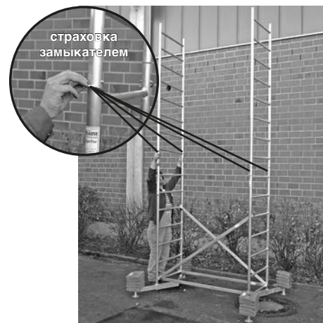
Базовая конструкция с первой и второй надстройками
