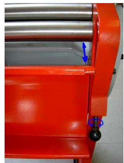
Die vordere obere Rolle kann mittels Drehung der Flügelschraube um 90°, einseitig herausgenommen werden um ggf. geschlossene kreisrunde Werkstücke herausnehmen zu können. Zudem müssen die beidseitig angeordneten Niederhalterschrauben, die dem sicheren Sitz der oberen Rolle dienen herausgedreht werden.
