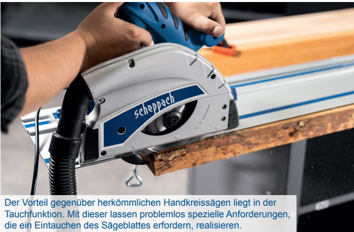
Selbst massive Bohlen lassen sich mühelos mit der PL55 besäumen.
