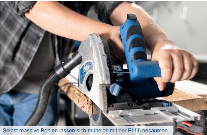
Selbst massive Bohlen lassen sich mühelos mit der PL55 besäumen.
