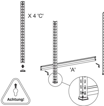
Bringen Sie die Fußendkappen auf die Klammern 'C' an. Achten Sie auf eine aufrechte Position. Mit einem Gummihammer können Sie die Klammern 'A' leicht in die Schlüsselöcher klopfen. Lassen Sie ein Schlüsselloch frei, wie in der Abbildung gezeigt.
