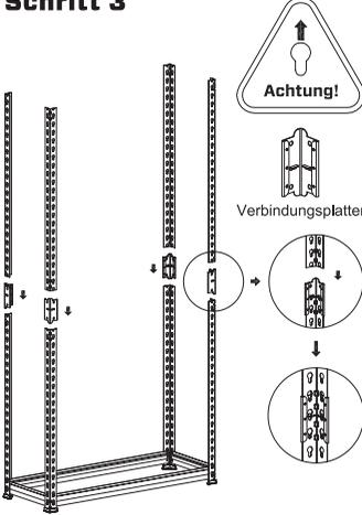
Legen Sie die erste MDF-Platte ein um ein Knicken der Klammern zu vermeiden. Verbinden Sie die oberen Klammern 'C' mit Hilfe der Steckerstifte und den Verbindungsplatten mit den unteren Klammern 'C'.
