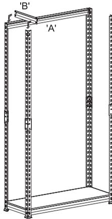
Befestigen Sie die Klammern 'A' ganz oben an den Klammern 'C'. Wiederholen Sie den Vorgang mit den Klammern 'B'.
