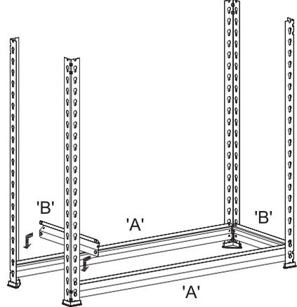
Bringen Sie die Klammern 'B' als seitliche Halterungen an und verwenden Sie die gegenüberliegenden Seiten - Klammern 'A' (aus Schritt 1) als Richtschnur für die Höhe.
