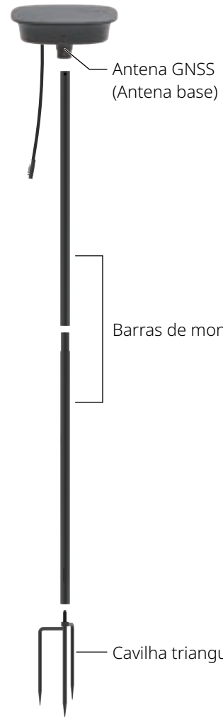
Estação de referência RTK
