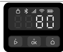
Charge L'écran affiche le niveau de la batterie en chiffres.
