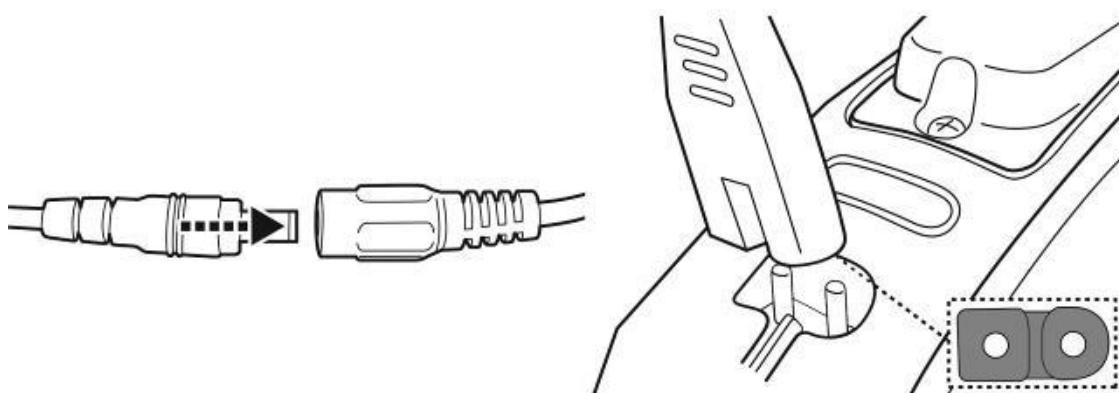
3. LADEADAPTER AM STROMSTECKER 230V ANSTECKEN. BEIM LADEVORGANG LEUCHTET DIE KONTROLLEUCHTE ROT. LADEDAUER CA. 5 – 6 STUNDEN. BEI VOLLLADUNG LEUCHTET DIE KONTROLLEUCHTE GRÜN.
