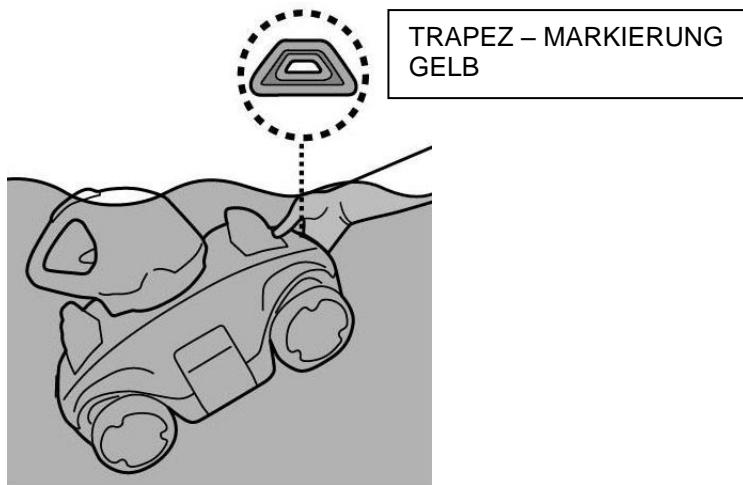
**ACHTUNG!** SOLLTEN SIE DEN ROBOTER AM ANDEREN ENDE AUS DEM POOL HEBEN WOLLEN (KEIN HANDGRIFF AN DIESER STELLE!) KANN DER SCHMUTZ IM FILTER ÜBER WASSERDRAINAGEKLAPPE WIEDER ZURÜCK INS POOL GELANGEN!
