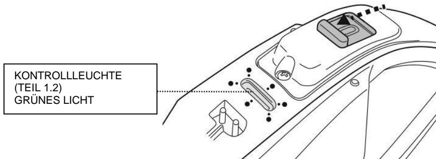
**ACHTUNG!** MOTOR STARTET AUTOMATISCH WENN DER ROBOTER VOLLSTÄNDIG IM WASSER UNTERGETAUCHT IST BZW. WENN SICH DER SENSOR AM DREHBAREN KOPF UNTER WASSER BEFINDET.
