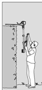
Hohes horizontales Schneiden: Motoreinheit um 75° geneigt, Teleskoprohr verlängert
