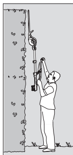
Hohes vertikales Schneiden: Teleskoprohr verlängert
