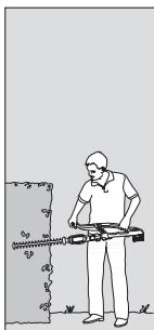
Seitliches Schneiden: Teleskoprohr eingefahren
