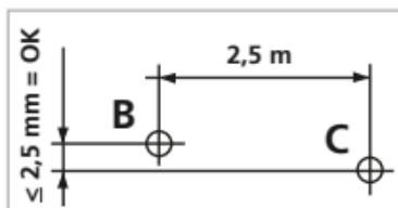
Ruotare la croce di collimazione laser di circa 2,5 m verso destra e segnare il punto C. Controllare se la linea orizzontale passante per il punto C si trova alla stessa altezza del punto B  $\pm 2,5$  mm. Ripetere la procedura ruotando la croce di collimazione verso sinistra.
