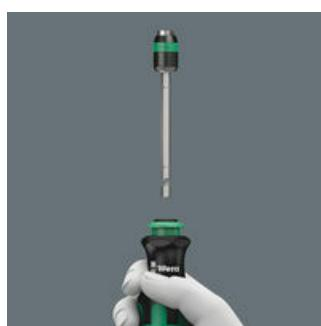
Durch erneutes, kräftigeres Betätigen der Hülse wird der Lösemechanismus durch einen deutlich hör- und fühlbares Überwinden des Arretierwiderstandes gelöst. Die Teleskopklinge kann entnommen und als Maschinenadapter eingesetzt, sowie in die Ausgangslage zurückgeführt werden.
